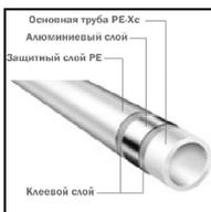
Труба предназначена для систем отопления, водоснабжения и холодоснабжения. Основной многослойной конструкции является внутренняя несущая труба из полиэтилена, сшитого электронно-лучевым методом (PE-Xc). Алюминиевый слой выполняет антидиффузионные и стабилизирующие функции. Наружный слой из полиэтилена (PE) белого цвета защищает трубу от ультрафиолетового излучения и механических повреждений
