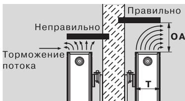
100-процентная теплоотдача возможна лишь при свободной циркуляции воздушного потока, то есть когда под и над радиатором есть зазоры. Верхний зазор можно определить на практике таким образом: глубина радиатора + 10% или  $OA = T \times 1,1$ . Если по техническим причинам использование такого зазора невозможно, то это повлияет на теплоотдачу радиатора.
