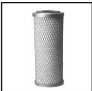
Элемент изготовлен из спеченого активированного угля 9 7/8" x 4 1/2" к Big Blue 10" производительность – 12 л/мин, ресурс – 18000 л.
