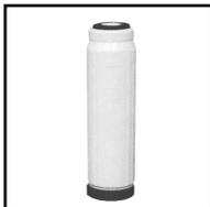
Серия угольных элементов с элементом KDF. Гранулированный активированный уголь производит очистку воды от органических примесей (хлор; хлорорганика и тд), а элемент KDF является причиной окисления и удаления из воды металлов (железо; свинец; мышьяк). Также удаляет сероводород и хлор. Кроме этого элемент KDF является бактерицидной и бактериостатической добавкой, подавляющей развитие микроорганизмов развивающихся на угле.
