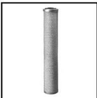
Элемент изготовлен из спеченого, активированного угля 20" x 2 1/2", производительность – 12 л/мин, ресурс – 12000 л.
